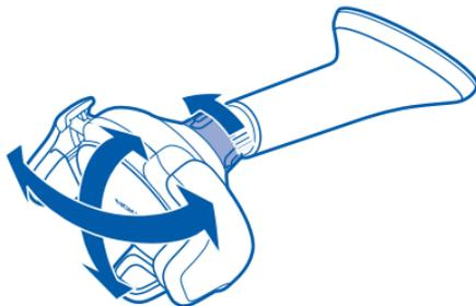
**Sugerencia:** ¿El soporte no gira fácilmente? Para aflojar la tuerca de presión, gírela en la dirección de las agujas del reloj.
